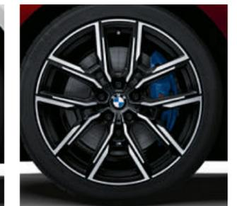
□ Jantes aérodynamiques M 858 M 18", bicolores Schwarzgrau, polies au diamant, dimension des roues 8,5J x 18, pneus 245/45 R18.<sup>2,3</sup>
