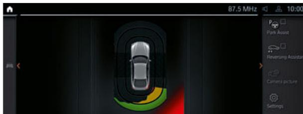
□ Le Park Assist<sup>1</sup> gare le véhicule de manière autonome dans les emplacements en créneau et en bataille et le fait sortir de même des emplacements en créneau. La fonction s'active en appuyant sur un bouton ou sur engagement de la marche arrière. Le système prend en charge la direction, les accélérations et les freinages, il ne vous reste plus qu'à superviser la manœuvre de stationnement.
