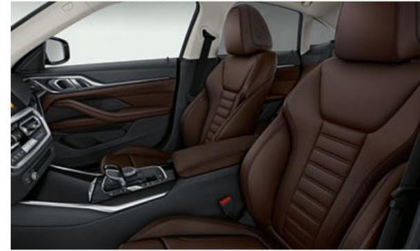
■ Les sièges sport pour le conducteur et le passager avant procurent un soutien latéral optimal grâce à des rebords plus saillants, avec appui des cuisses réglable manuellement. De plus, l'assise peut être réglée manuellement dans le sens de la longueur et de la hauteur.
