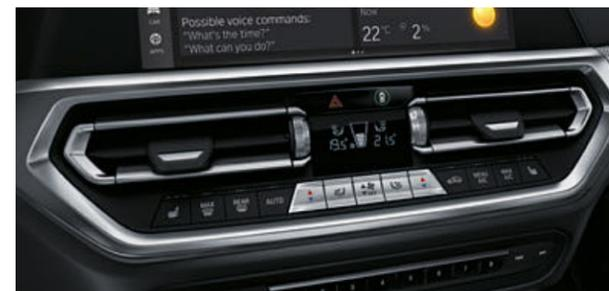
□ Vous, le passager avant ainsi que les passagers arrière pouvez régler séparément le climatiseur automatique 3 zones ainsi que la régulation automatique de la température. Le système comprend le contrôle automatique de recyclage de l'air, un microfiltre à charbon actif, un capteur de buée et d'ensoleillement, ainsi que des diffuseurs d'air à l'arrière avec un affichage numérique.
