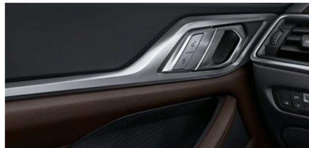
□ Les applications galvanisées exclusives sur les éléments de commande pour les lave-vitres, le centre de commande des portières, l'interrupteur de verrouillage des portes et, selon l'équipement, les touches multifonctions du volant suscitent un aspect de haute qualité.
