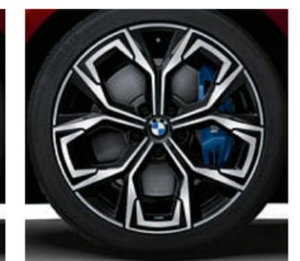
□ Jantes aérodynamiques M 860 M 19", bicolores Schwarzgrau avec pneus mixtes, polies au diamant, dimension des roues avant 8,5 J x 19, pneus 245/40 R19, dimension des roues arrière 9J x 19, pneus 255/40 R19.<sup>2</sup>
