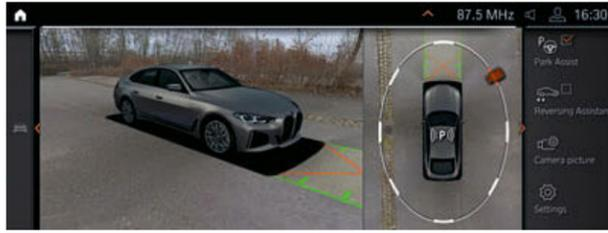
□ Le Park Assist Plus<sup>1</sup> facilite les manœuvres de stationnement du véhicule. Il comprend entre autres le système Surround View avec Top View, Panorama View et Remote 3D View, ainsi qu'une aide au stationnement latéral, la fonction de freinage d'urgence Active Park Distance Control, le Park Assist avec assistance au stationnement en créneau et en bataille et l'assistant à la marche arrière.
