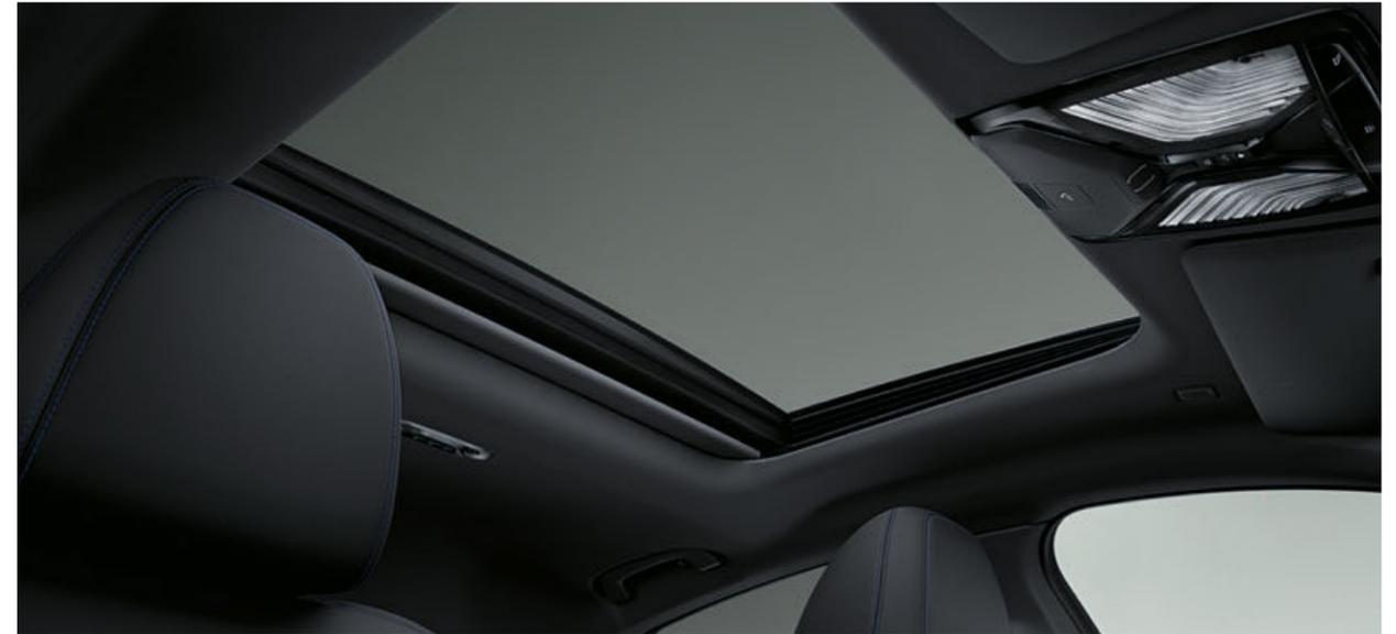
□ Le toit ouvrant à commande électrique avec fonction coulissante et basculante, store coulissant électrique, protection anti-coincement et ouverture et fermeture confort permet un passage régulier de l'air et par conséquent un climat agréable dans l'habitacle. Le pare-vent intégré empêche les courants d'air dans l'habitacle et réduit les bruits de vent.
