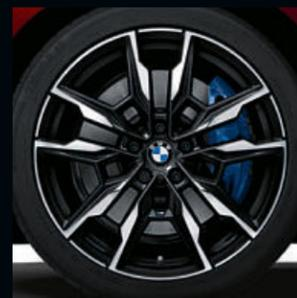
■ Jantes aérodynamiques M 858 M 18", bicolores Schwarzgrau, polies au diamant, dimension des roues 8,5J x 18, pneus 245/45 R18.
