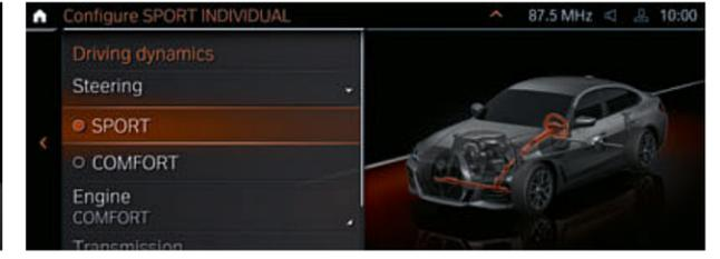
□ Le Variable Sport Steering<sup>2</sup> avec Servotronic garantit un comportement direct et agile en diminuant l'ampleur des manœuvres du volant. Il réagit au braquage du volant en appliquant des rapports de démultiplication variables. Il en résulte une meilleure agilité en conduite sportive et une diminution de l'effort musculaire à produire sur le volant dans les manœuvres de stationnement et de changement de direction.
